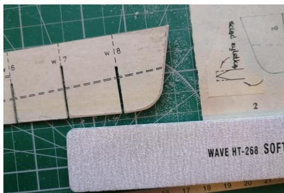
Сборку каркаса начинаем с соединения килевой рамки и шпангоутов. Место каждого шпангоута указано на килевой рамке буквой и цифрой.
