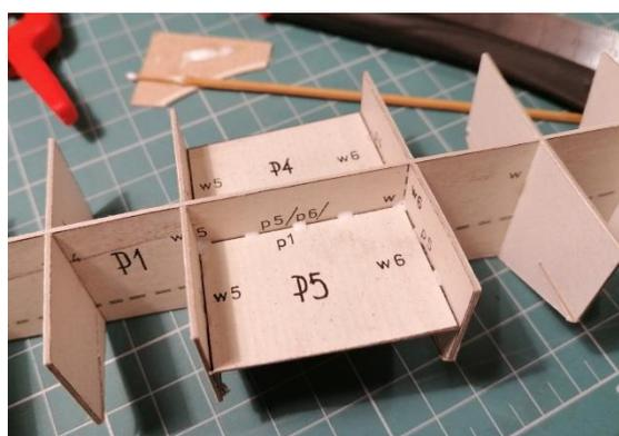
Килевую рамку со шпангоутами накладываем на деталь Р6 – палубу. Фиксируем детали по заранее размеченным местам.
