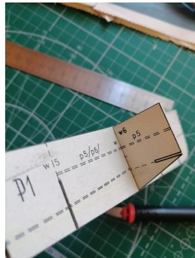
Для склеивания прекрасно подойдёт клей ПВА-М, а для усиления соединений деталей каркаса рекомендую использовать картонные «брусочки», оставшиеся после вырезания пазов в деталях и «уголки» из тонкого картона.
